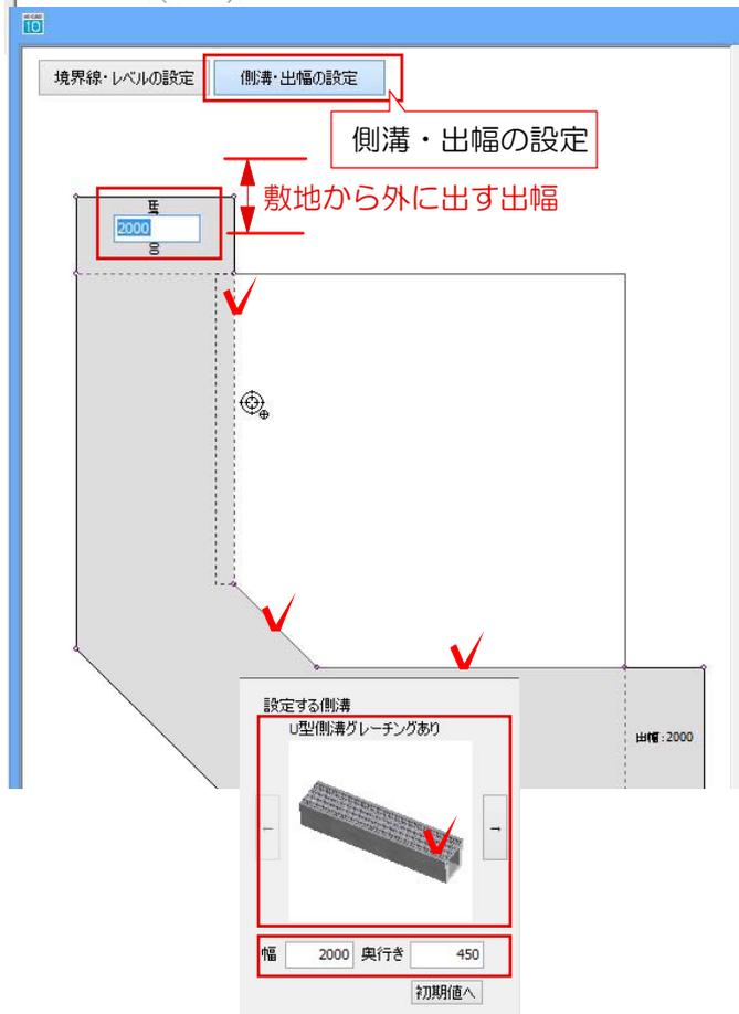
①-4 側溝・出幅の設定を選択し、出幅をクリックで選択し入力します。
