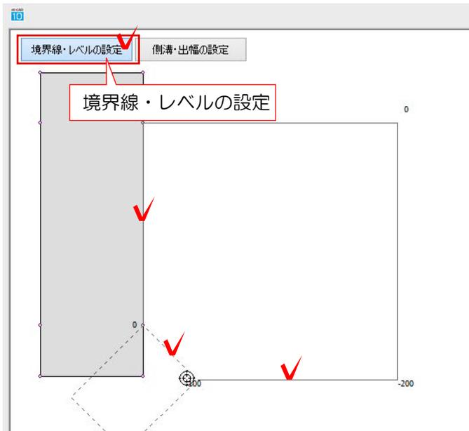
①-3 境界線・レベル設定を選択し、作成したい部分に合わせて $\odot$ の時にクリックで道路を作成します。
