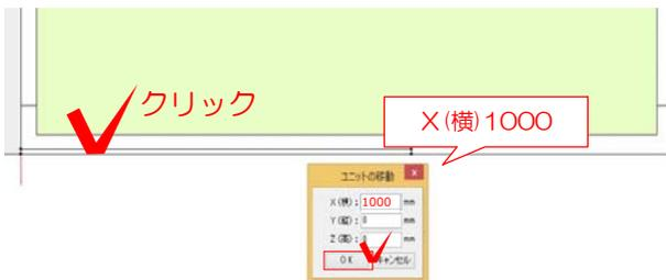
5：擁壁の角に配置したシャッターを、擁壁の中央に移動します。
