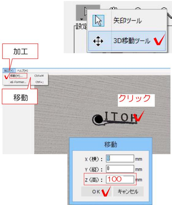
1: eE-Painterの画面右上矢印カーソルをクリックし、3D移動ツールを選択します。
