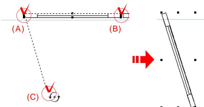
左図のように回転する基準点(A)、回転軸(B)、回転する角度(C)を指定して、扉を開けます。
