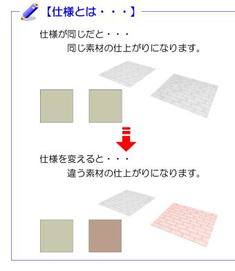
作図をする時に必ず設定する項目です。 オーセブンCADでは図形に割り当てる素材のことを「仕様」と呼びます。ユニットの中にはあらかじめ仕様が割り当てられています。必要があればこの仕様を変えて、違う素材として設定をします。
