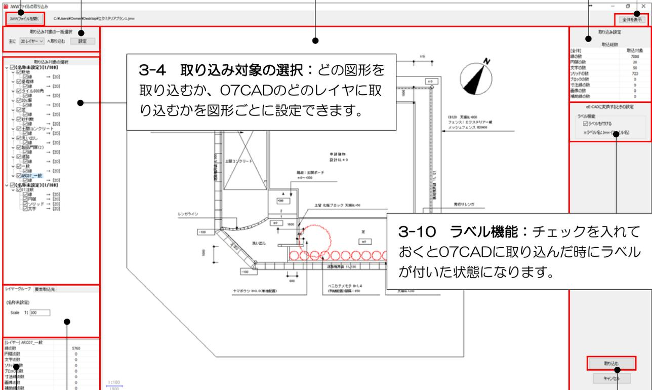
3-4 取り込み対象の選択：どの図形を取り込むか、O7CADのどのレイヤに取り込むかを図形ごとに設定できます。
