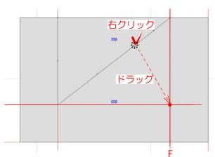
2-10:右側も2-7からの作業と同様に右端の 先端をFの補助線に合わせ、右クリックで頂点 を追加し補助線の交点に移動します。
