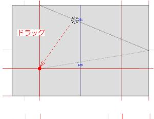
2-9:2-8で作成した頂点を夢のマークの時にクリックして選択し左下の補助線の交点にドラッグで配置します。
