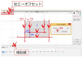
2-6: Aの補助線を選択して左上の加工のオフセットを選択します。オフセット距離を300と入力しOKを選択します。
