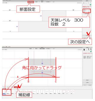
2-3: 天端レベル300と入力しEnterで確定します。段数2を設定後、次の設定へを選択します。
