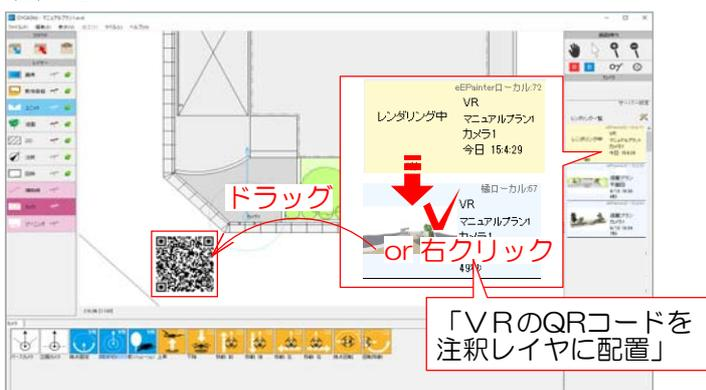
(2)-9 ドラッグor右クリック「VRのQRコードを注釈レイヤに配置」でQRコードを配置します。
